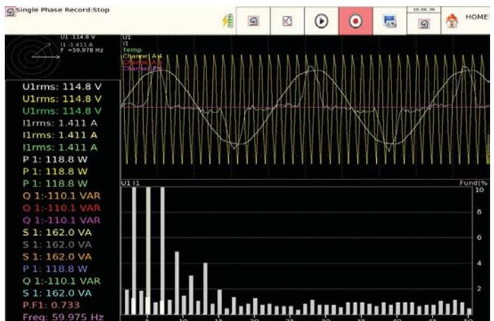
在Δ、Δ（Aron）或星形三相配置中同时分析多达 4 个电力网络。菲涅尔图、示波器模式和谐波（高达 50 次）的实时显示可测量和显示高达 1kHz 的电压、电流和频率。
