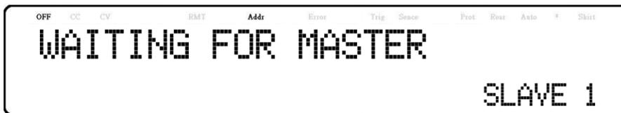
在所有连接的从属设备上启用链模式(chain mode)后，重复该过程以在主（地址=1）电源上启用链(chain)方式。主电源将搜索并自动连接到从电源。如果设置成功，从属电源将显示**Connected(已连接)**。
