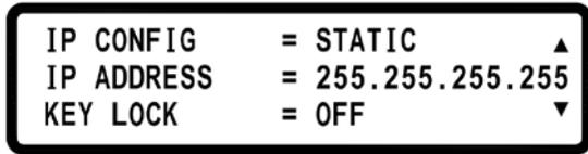
**IP CONFIG** : 设定 IP 取得方法, 静态(STATIC)由用户 自行输入, 或动态 (DHCP)由服务器分配 IP
