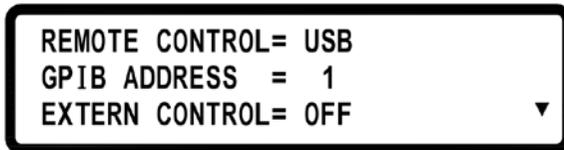
REMOTE CONTROL： 选择传输接口 (USB/GPIB/ETHERNET)
