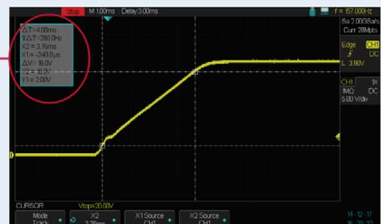
8600B可用内置的计时功能来观测输入电压的上升与下降时间,可以不须要依赖示波器来观测
